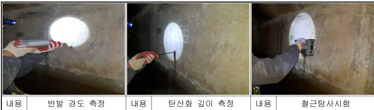
【사진 3.17】 진건분기 재료시험 전경
